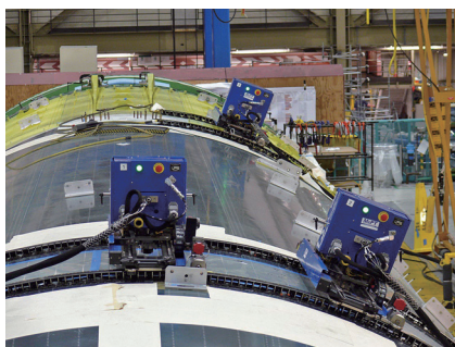
图2 柔性导轨制孔系统在波音777机身上的应用
